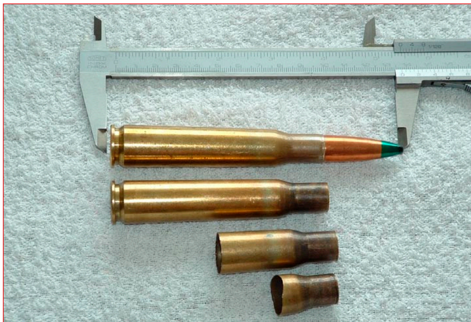
Rozerwane łuski kal 12,7 x 99. Wynik strzelania z wkm Browning (BMG) M2 HB z nadmierną odległością zaporową.
